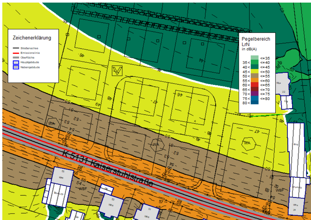
Abbildung 3: Rasterlärmkarte K 5131 Prognose in der Nacht in 3 m Höhe über Gelände ohne geplante Gebäude (Niveau des EG), unmaßstäblich
