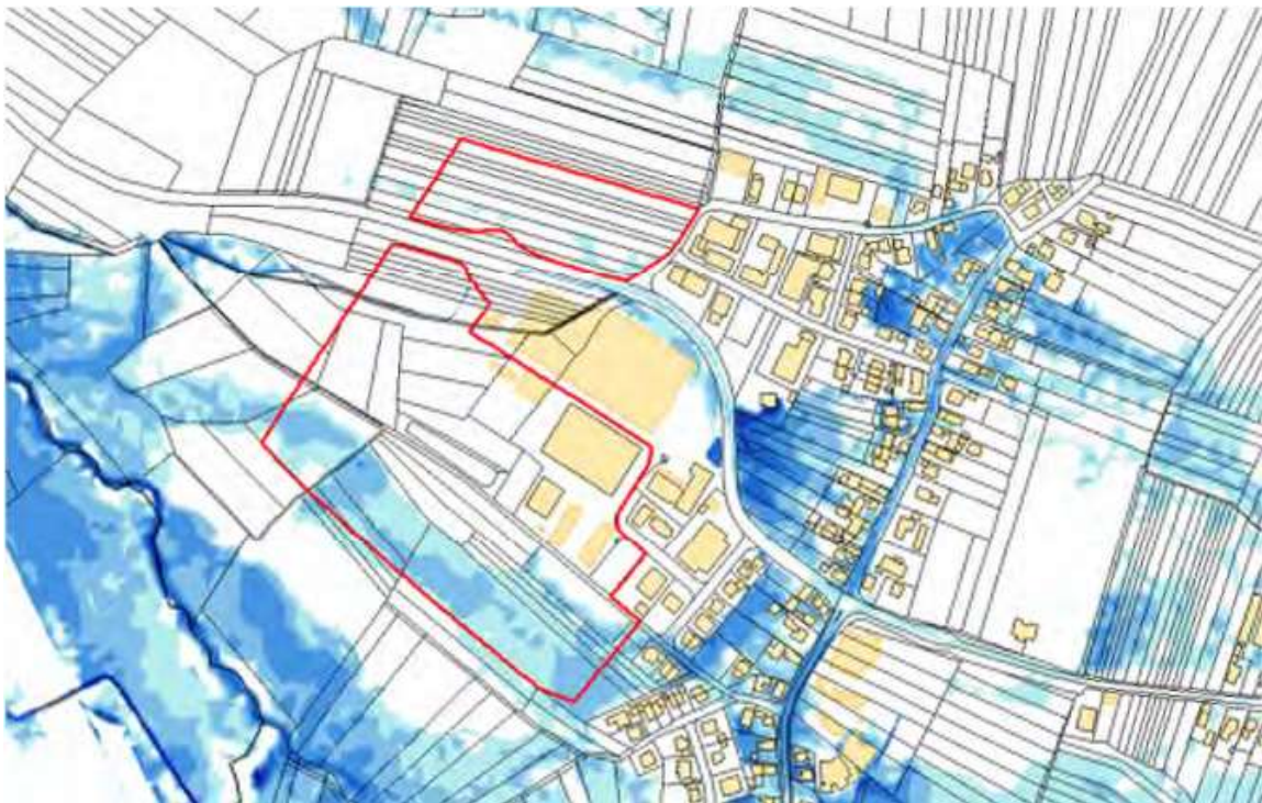
Überflutungsflächen nach Referenzmodell mit schematischer Darstellung des Plangebiets (rote Umrandung), o. M., Quelle: BIT Ingenieure, Stand 27.05.22.
